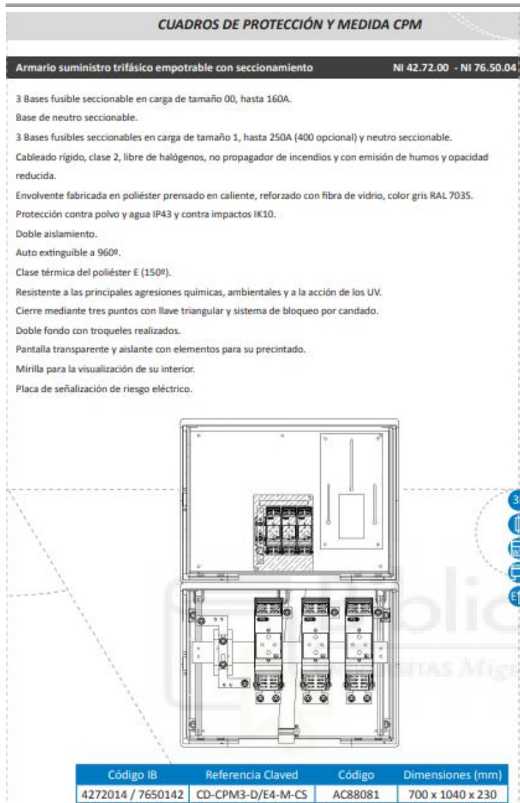
Figura 1. Conjunto de medida directa tipo 4. Detalle obtenido del catálogo de productos CLAVED.
