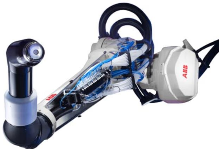
Figura 2.37 - Disposición de los equipos de suministro y mezcla en el brazo robótico
