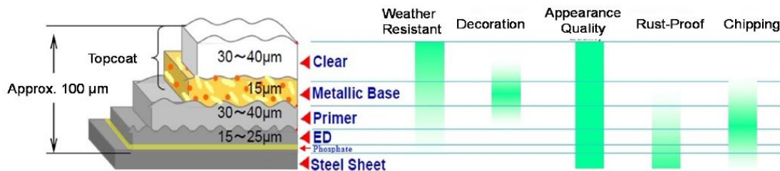
Figura 2.19 - Estructura de las capas del recubrimiento de un vehículo
