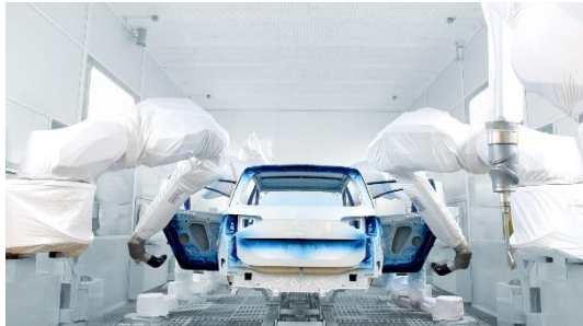
Figura 2.40 - Robots de pintura instalados en pared
