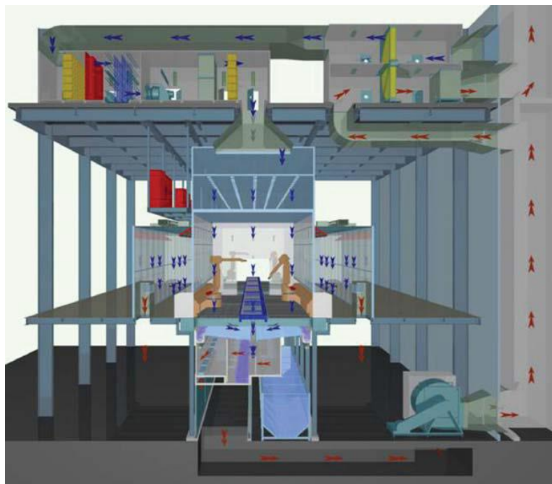
Figura 2.32 - Esquema de una cabina de pintado automatizada
