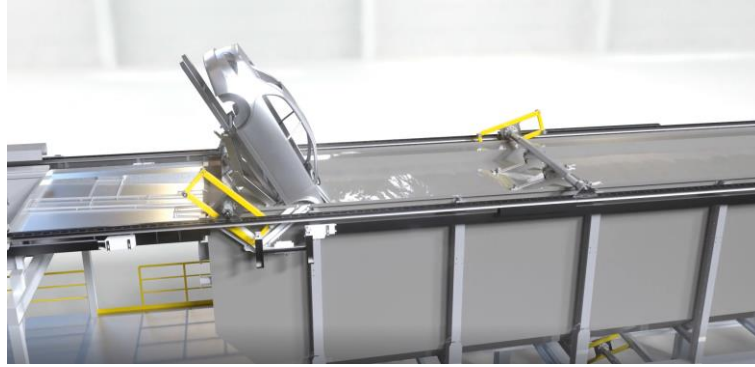
Figura 2.7 - Proceso de electrorecubrimiento catódico
