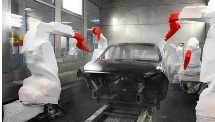
Figura 2.38 - Robots de pintura con cubiertas desechables
