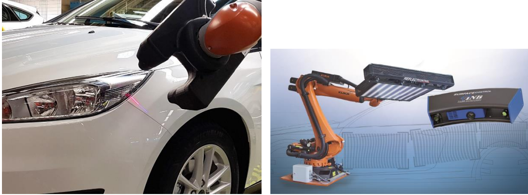
Figura 2.11 - Control de calidad del recubrimiento mediante robots
