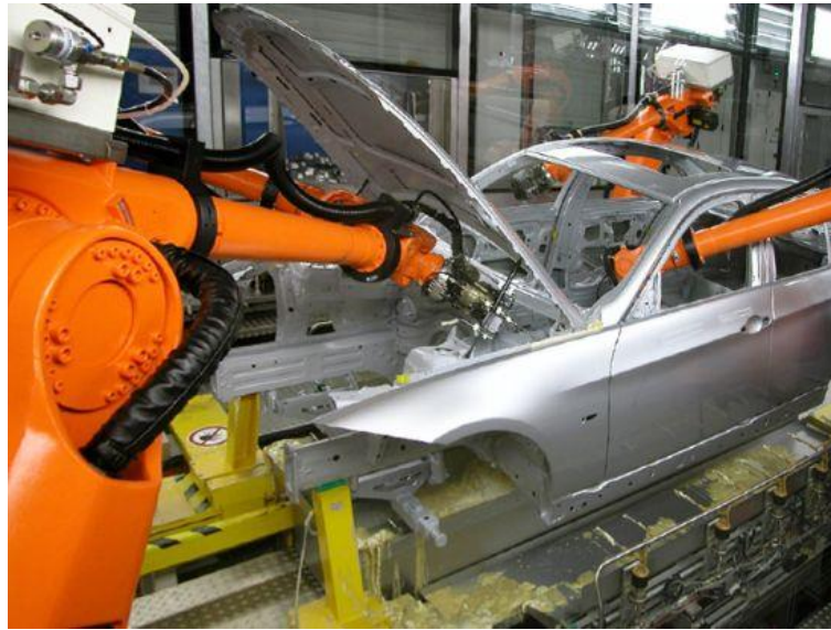
Figura 2.10 - Preservación de las cavidades mediante aplicación robotizada
