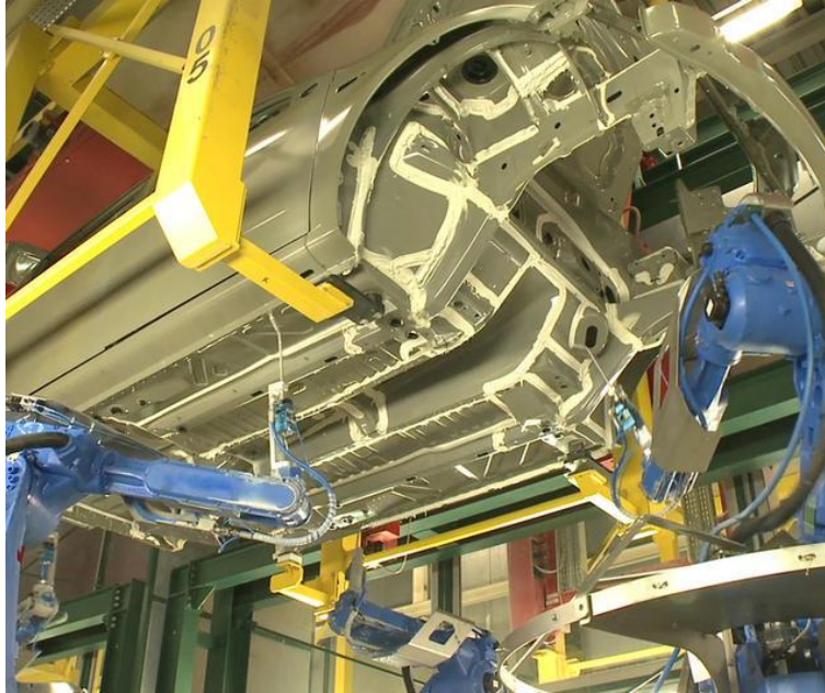
Figura 2.9 - Aplicación de los materiales de sellado
