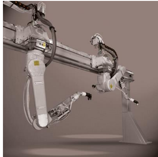
Figura 2.41 - Robots de pintura instalados sobre rail
