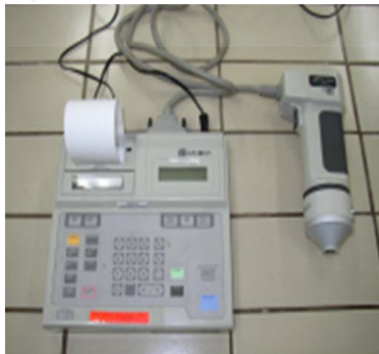
Fotografía 5: Colorímetro utilizado para medir el color.
