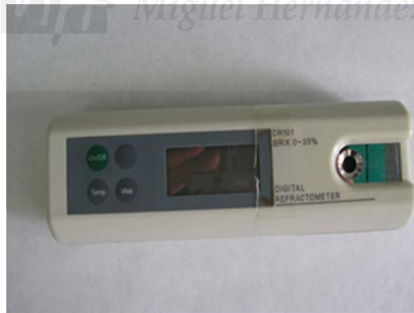
Fotografía 7: Refractómetro utilizado para medir los °Brix (SST).
