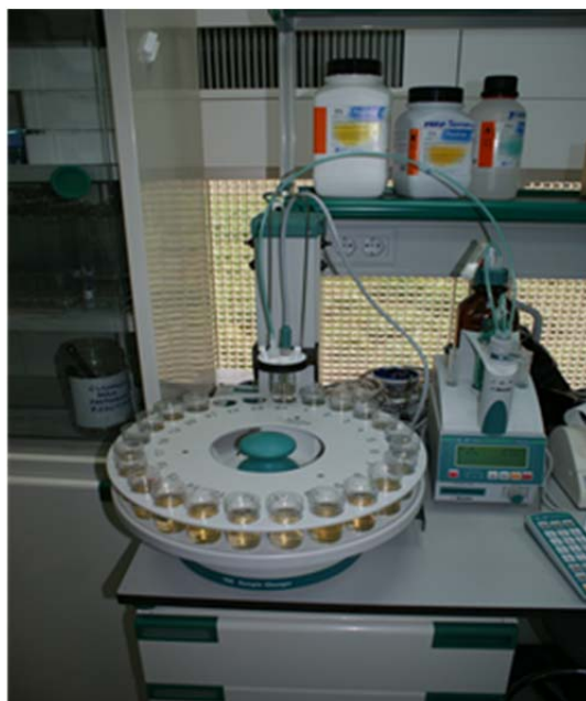
Fotografía 8: Valorador automático Methrom, utilizado para determinar la acidez.
