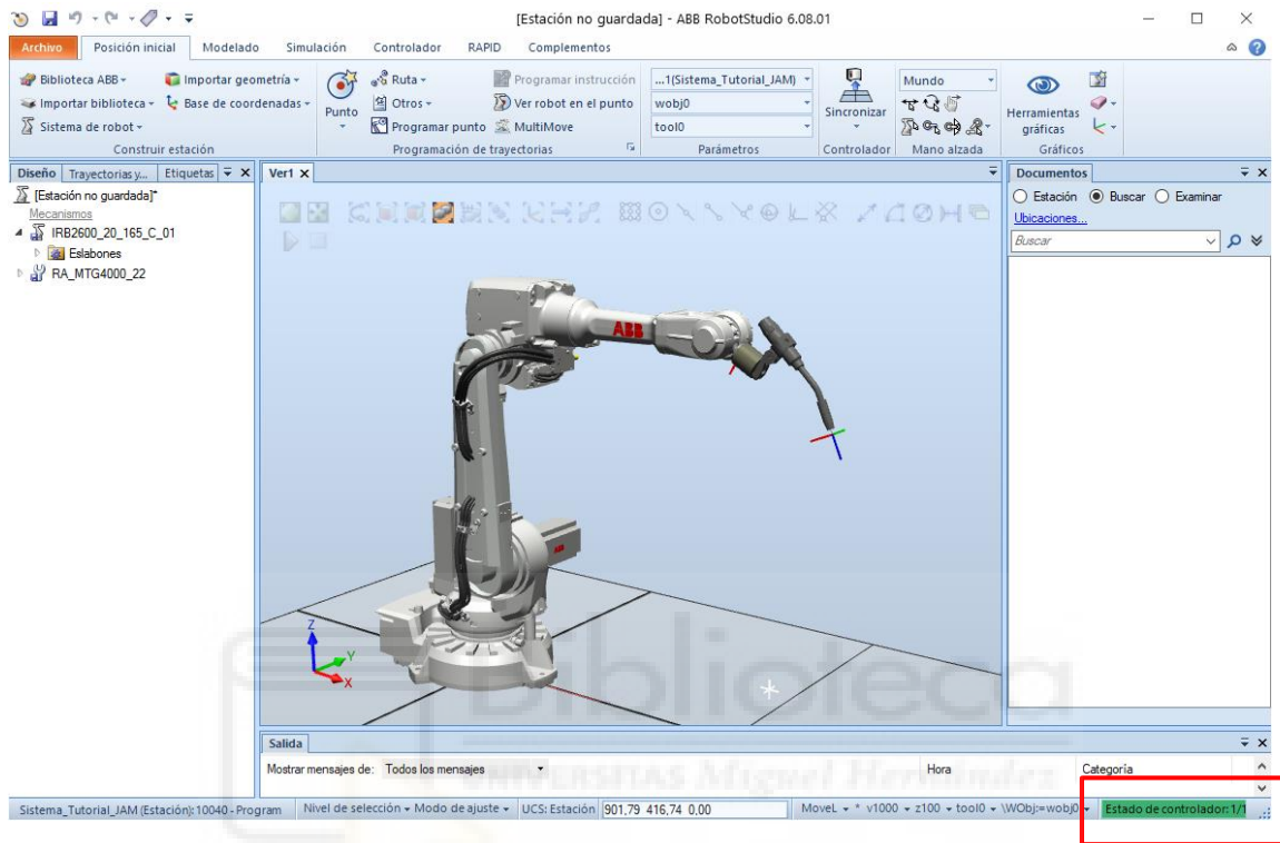
Figura 3.23 Controladora correctamente cargada
