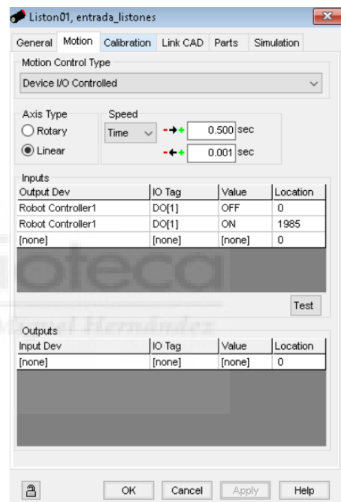
Figura 61 Parámetros movimientos Roboguide
