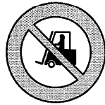
PROHIBIDO EL PASO A CARRETILLAS
