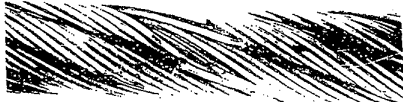
Cliché 3 - Roturas de alambres en un mismo cordón asociadas a un ligero desgaste. Justifica una operación posterior si está en la peor condición (rotura de alambres al ras de la bolsa) y no puede impedir un uso posterior a un uso autorizado.
