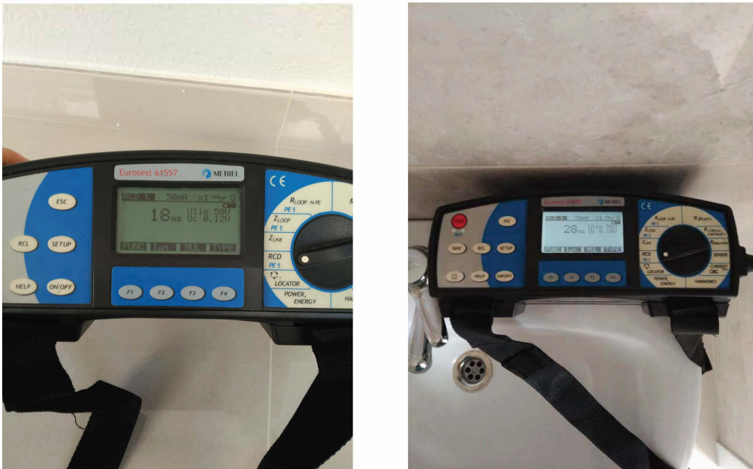
Fotografía 13. Detalle de la medición de los tiempos de disparo de distintos diferenciales (trastienda y baños).
