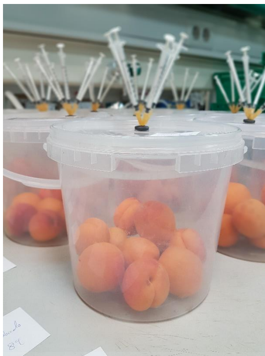
Figura 1.4: Recipientes herméticos para la determinación de la tasa de respiración y producción de etileno.
