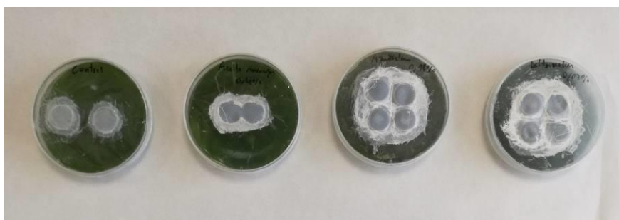
Figura 10. Montaje final del ensayo con placas Petri selladas con Parafilm y rotuladas en función del tratamiento.
