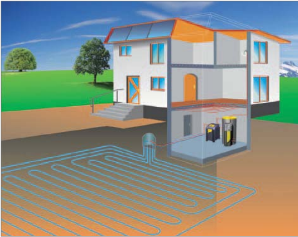
Fig.: captación superficial horizontal
