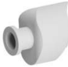
Ilustración 35: diseño 3D de la salida del electrodo del sistema KronoSafe® versión 2.
