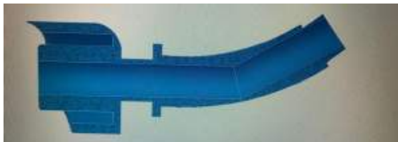
Ilustración 50: imagen en 2D de la pieza de salida del electrodo, cortada sagitalmente, en la que se observan los dos trayectos internos rectos tras optimización de la pieza para moldeado.
