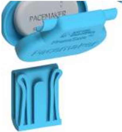
Ilustración 36: diseño 3D de la pieza de sujeción de la carcasa. KronoSafe® versión 3.
