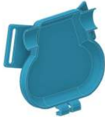
Ilustración 49: diseño 3D de la parte trasera de la carcasa del generador con la orejuela lateral para agarre del sistema a la cinta. KronoSafe® versión 4.
