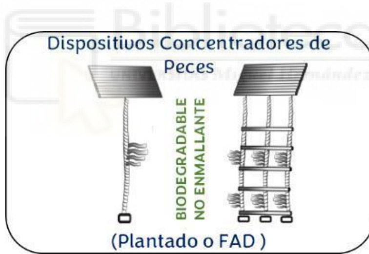
Figura 2. Red FAD no enmallante (izquierda) y red FAD tradicional (derecha).
