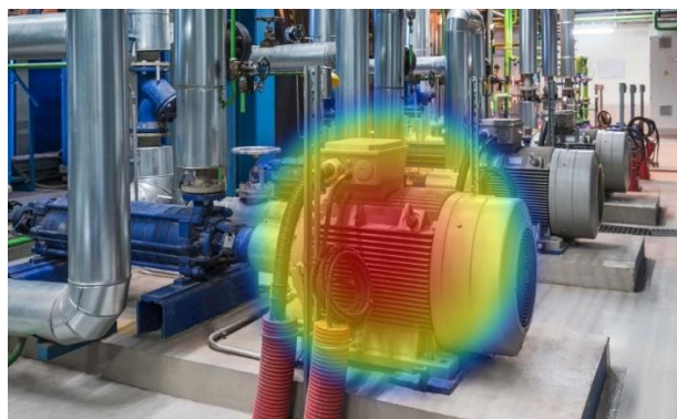
Figura 1.19. Imagen acústica en escala RGB de entorno industrial con motores eléctricos
