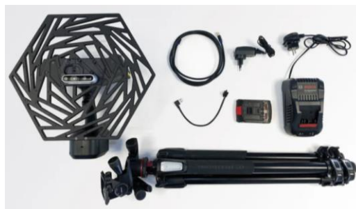
Figura 3.01. Ejemplo de cámara acústica compacta all in one [II]
