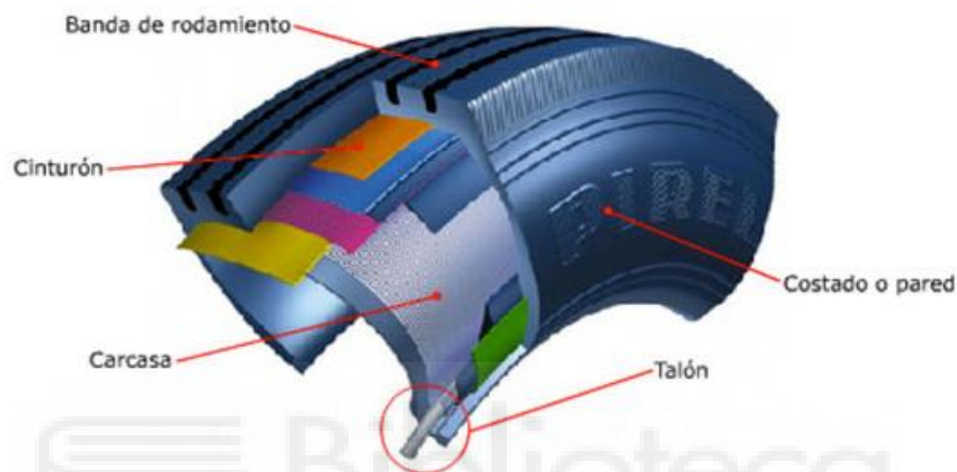
Figura 1.03. Partes del neumático
