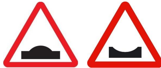
Figura 1.11. Señales viales de peligro por aproximación a un resalto y un badén, respectivamente
