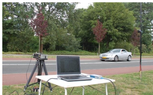
Figura 1.14. Toma de medidas con el método SPB [III]
