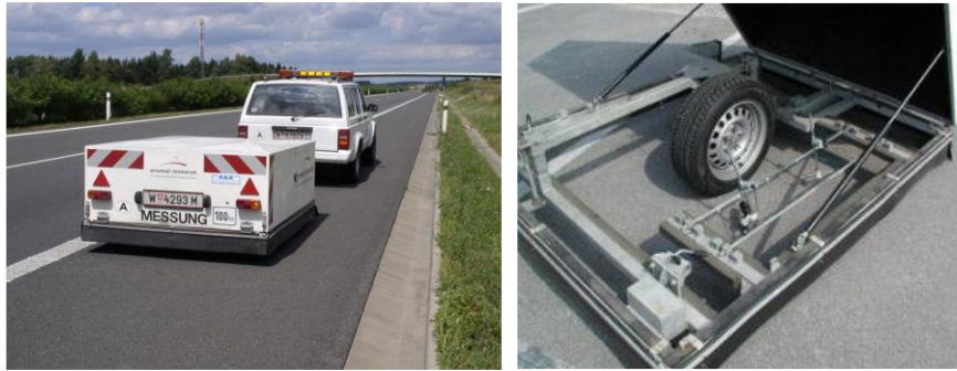
Figura 1.16. Toma de medidas con el método CPX. Medida tomada en remolque [6]
