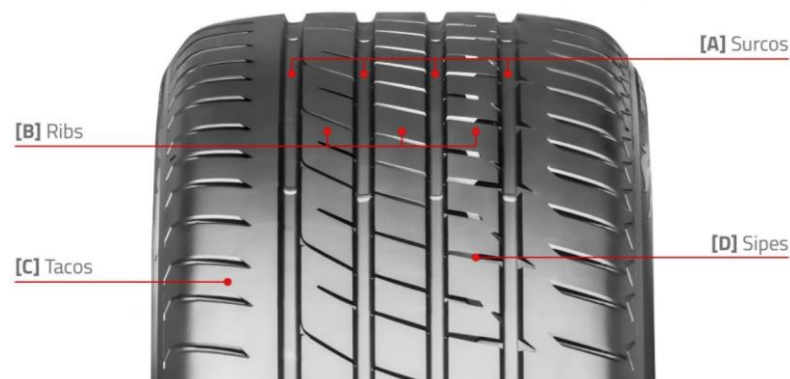
Figura 1.04. Partes de la banda de rodamiento [1]
