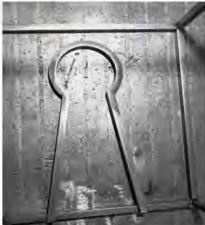
Fig.46 Soldadura del ojo de cerradura lateral.
