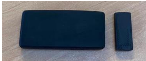
Figura 48. Pieza de 5 mm impresa para caracterización de ABS EC TORWELL en guía WR 90 junto a material ABS EC KIM YA para guía WR 90
