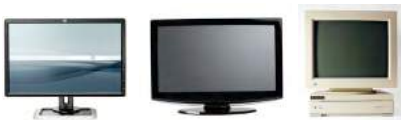
Fig. 15. Monitor (izquierda a derecha) LED, LCD y CRT. Fuente: Internet [Última consulta: 01/06/2015].
