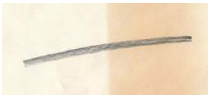
Fig. 34. Único papel no estucado poco resistente al envejecimiento. En la imagen se observa que la parte de papel expuesta a la luz (derecha) tiene un tono más amarillento que la parte no expuesta a la luz (izquierda). Fuente: material propio.
