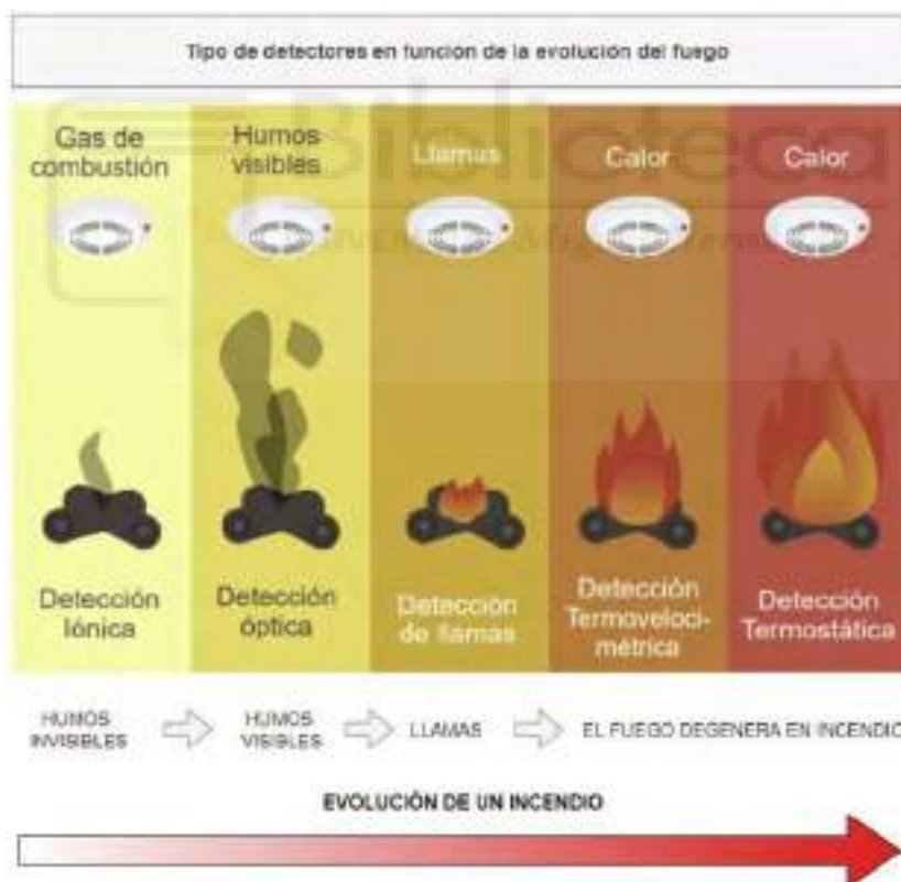
ILUSTRACIÓN 50.- TIPOS DE DETECTORES DE INCENDIO EN FUNCIÓN DE LA EVOLUCIÓN DEL FUEGO
