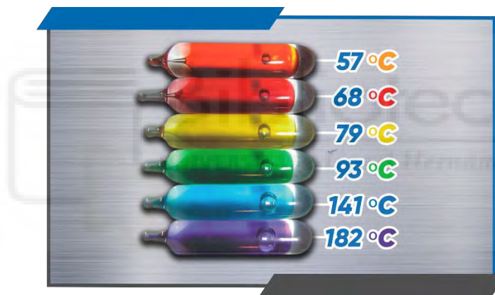
ILUSTRACIÓN 56.- TEMPERATURA DE FUNCIONAMIENTO DE ROCIADORES
