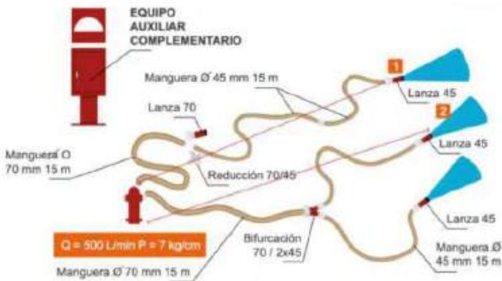
ILUSTRACIÓN 54.- FUNCIONAMIENTO DE UN HIDRANTE EXTERIOR
