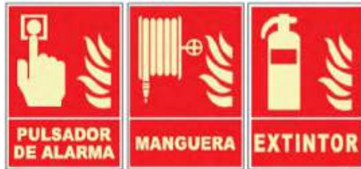
ILUSTRACIÓN 65.- SEÑALIZACIÓN DE EQUIPOS DE LUCHA CONTRA INCENDIOS
