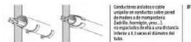
ILUSTRACIÓN 79.- MÉTODO DE INSTALACIÓN B1 SEGÚN NORMA
