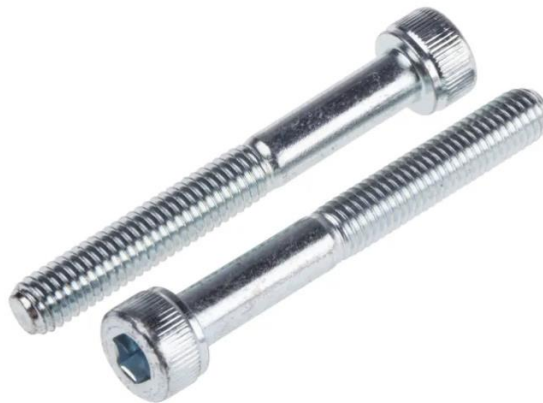
Fig. 4.7.2.3.2. Tornillo Allen de cabeza cilíndrica RS PRO, M5 x 40mm, paso de rosca 0.8mm, de Acero.
