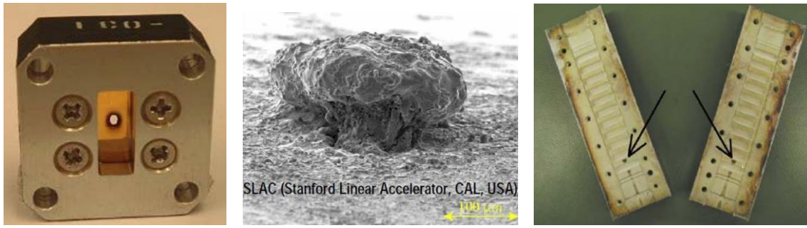
Fig. 2.5.1. Daños producidos por el efecto multipactor en diferentes dispositivos de microondas. Imágenes de [5]
