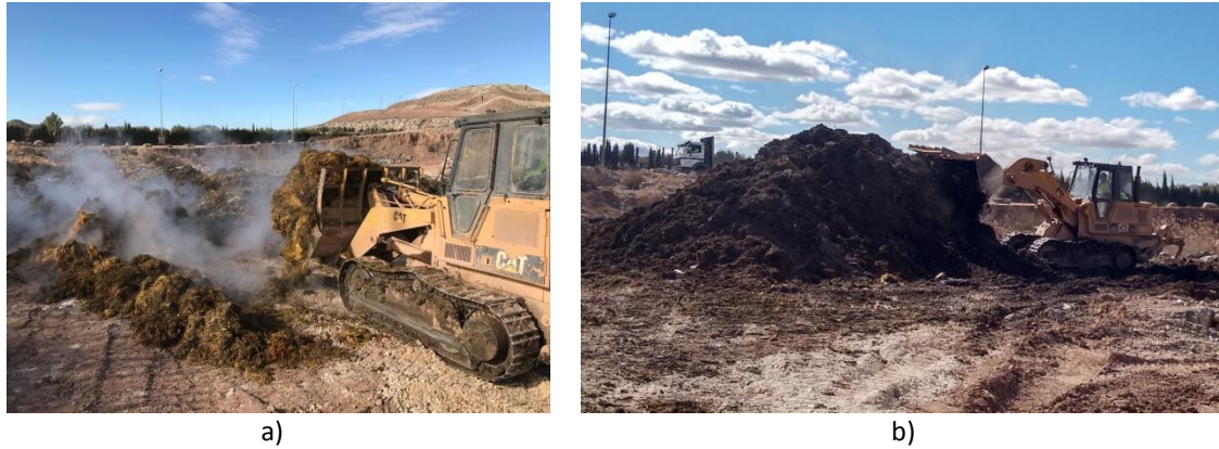
Figura 3.10. Mezcla de materiales mediante sistema de sándwic (a) hasta formar un gran pila (b).
