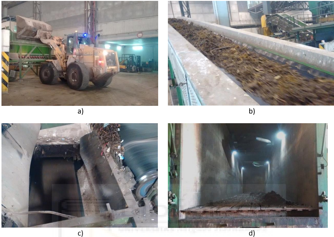
Figura 3.6. Secuencia de la operativa de carga de la pila túnel: a) alimentación, b) transporte en cintas y c) y d) caída al interior del túnel.
