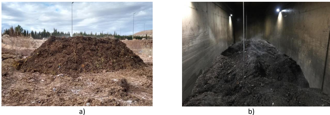
Figura 3.4. Sistemas de compostaje utilizados: a) abierto de pila exterior con volteo, pila control; y b) cerrado de túnel de compostaje con aireación forzada, pila túnel.
