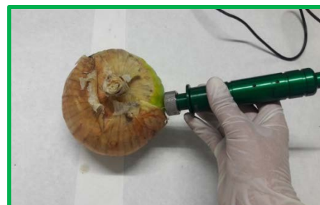
Foto 27 y 28: Durómetro y medida de la dureza en una de las variedades de cebolla estudiadas.
