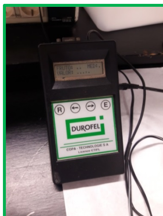
Foto 27 y 28: Durómetro y medida de la dureza en una de las variedades de cebolla estudiadas.
