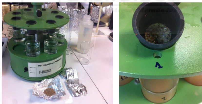
Figura 3.15. Punto de inicio en aparato wet-sieving y poso que queda después del agitado.
