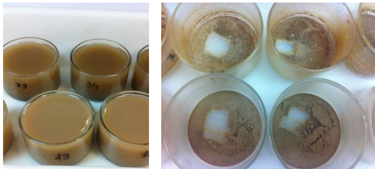
Fig 3.16. Vasos que se mandan a estufa y resultado después de evaporar.
