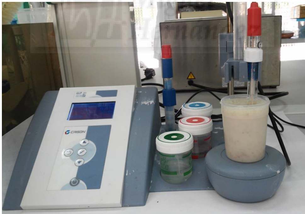
Figura 11. Medición de pH con el pH-metro modelo Crison GLP 21
