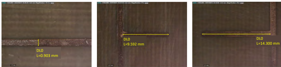
Figura 44. Mediciones de las pistas de la placa de Multi3D_Multi3D con DinoCapture.
