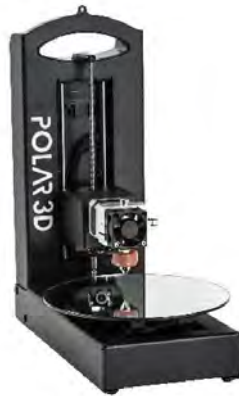
Figura 4. Impresora 3D polar. [14]
