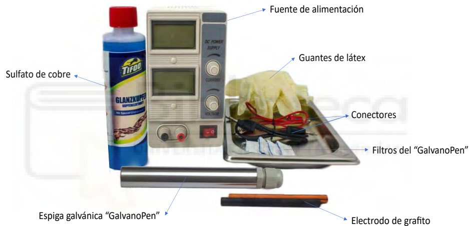
Figura 14. Proceso de galvanoplastia de espigas. [26]
