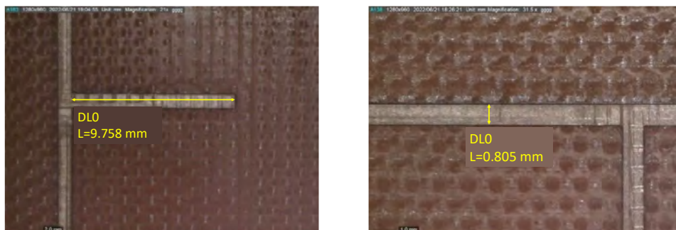
Figura 34. Mediciones del resonador corto de 10mm de Cobre_Cobre con DinoCapture.
