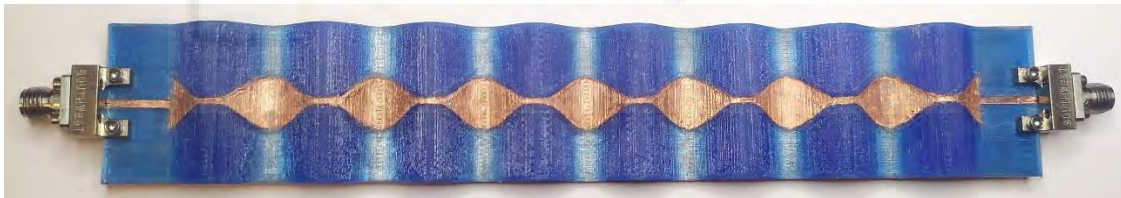
Figura 63. Estructura EBG fabricada con variaciones de altura y ancho cara top.
