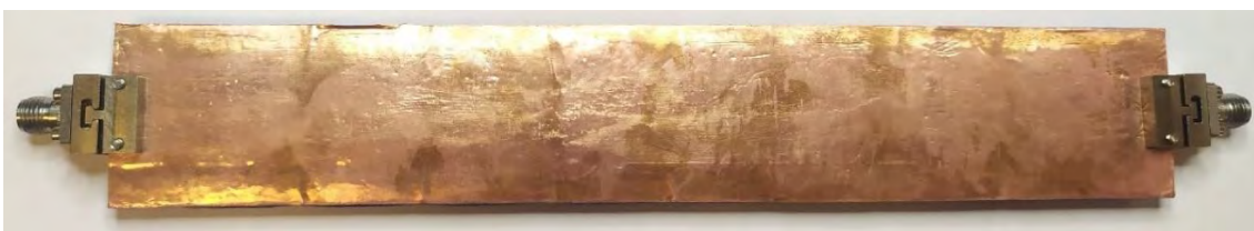
Figura 59. Estructura EBG fabricada con variaciones de altura cara bottom.
