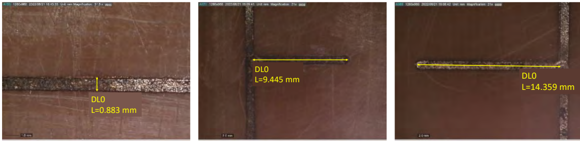
Figura 43. Mediciones de las pistas de la placa de Multi3D_Cobre con DinoCapture.
