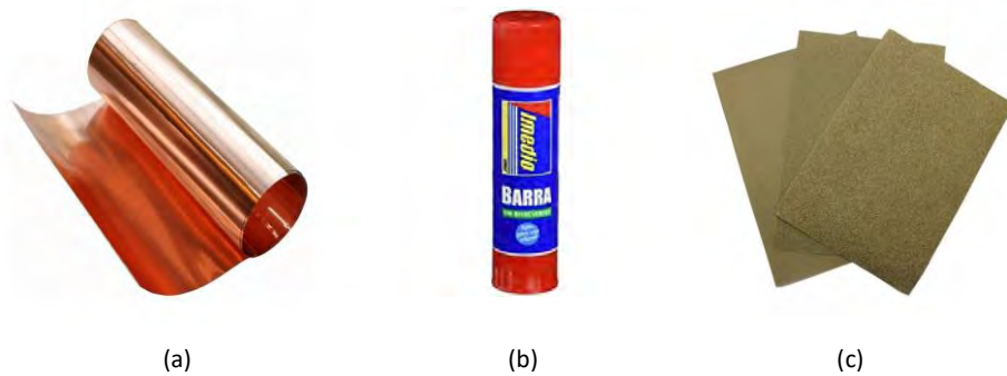
Figura 48. (a) Rollo de lámina de cobre de 35\mu\text{m} . (b) Pegamento de barra. (c) Papel de lija. [31]
