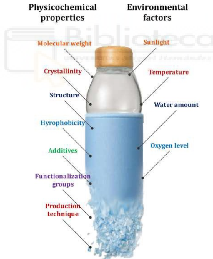
Figura 5. Propiedades fisicoquímicas y factores ambientales que afectan en la degradación biótica de polímeros plásticos. Fuente: Sameh Samir et al. , 2021.
