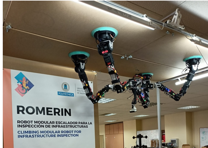
Figura 3: Ejemplo de robot con adhesión neumática: ROMERIN (UPM)
