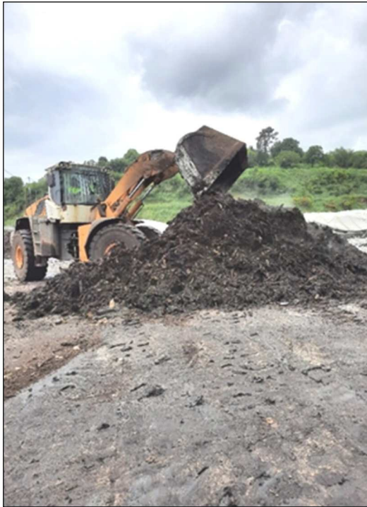
Figura 3.3. Mezclado de residuos con pala cargadora
