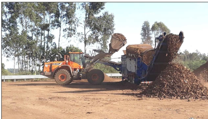
Figura 3.8. Cribado final con trómel
