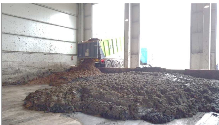
Figura 3.10. Descarga de lodos EDAR
