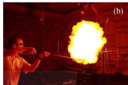
Ilustración 3 a) Foto de montaje experimental en cámara anecoica b) Explosión de un globo: Artículo[4]
