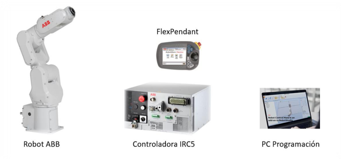
Figura 7 Elementos básicos de un sistema robótico
