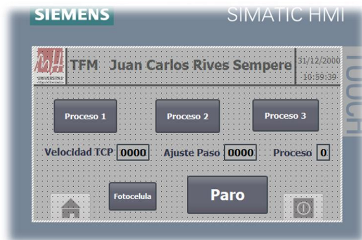
Figura 129 Menú principal con paro SCADA
