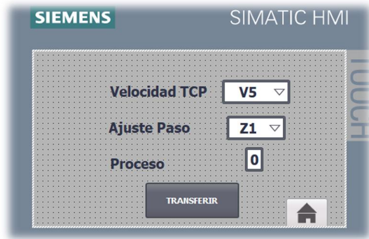
Figura 130 Variables modificables mediante SCADA
