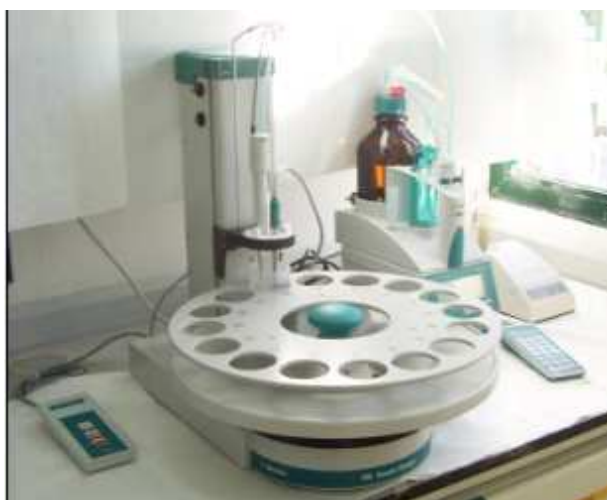
Fotografía 35: Phmetro Metrohm 760 Sample Changer para determinar la acidez.
