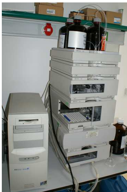
Fotografía 33: HPLC-DAD. Hewlett-Packard HPLC-1100 Series. Fuente: S. Castillo.
