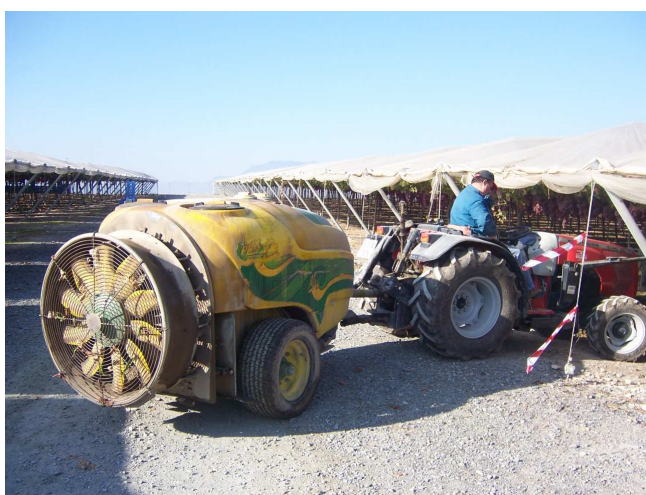
Fotografía 46: Pulverizador mecánico utilizado para aplicar el tratamiento pre-cosecha con gel de A. vera sobre las dos variedades de uva de mesa. Fuente: S. Castillo.
