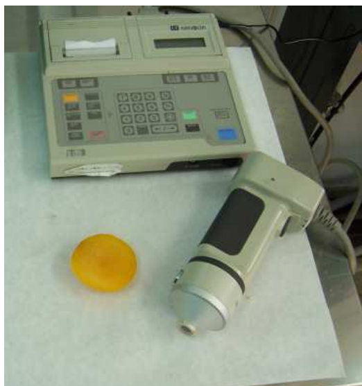
Fotografía 29: Colorímetro triestímulo modelo CR-300, utilizado para medir los parámetros de color. Fuente: S. Castillo.
