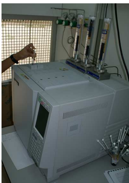
Fotografía 32: Cromatógrafo de gases Hewlett-Packard TM modelo 5890 a (Wilmington, DE). Fuente: S. Castillo.
