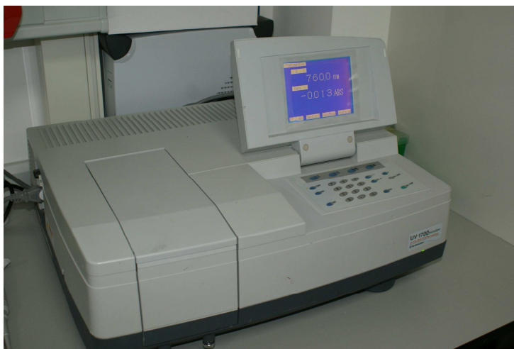
Fotografía 34: Espectrofotómetro modelo U.V-1700 PharmaSpec, utilizado para medir la absorbancia. Fuente: S. Castillo.
